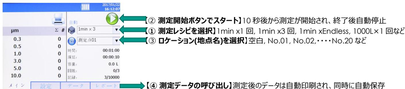
【④ 測定データの呼び出し】測定後のデータは自動印刷され、同時に自動保存
